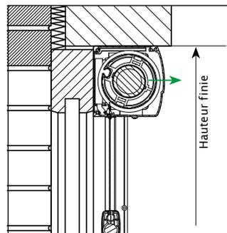
Avant-corps, devant le châssis à l'intérieur
